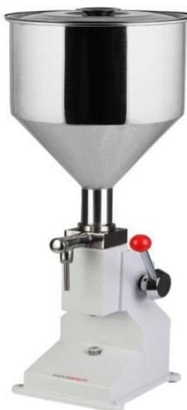
**Figura 5.** Máquina llenadora manual. Con capacidad de llenado de 3 ml a 50 ml, la regulación del llenado es mediante un tope mecánico el cual regula el recorrido de un embolo empujado por un pistón.
